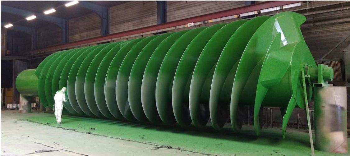
EDP avanza en la construcción de la primera gran central hidroeléctrica con hidrotornillos de Asturias. Ubicada en la presa de La Florida, en Pilotuerto (Tineo), será una de las mayores instalaciones del mundo de sus características, con dos hidrotornillos en serie de 19 metros de largo y casi 4 metros de diámetro cada uno.
