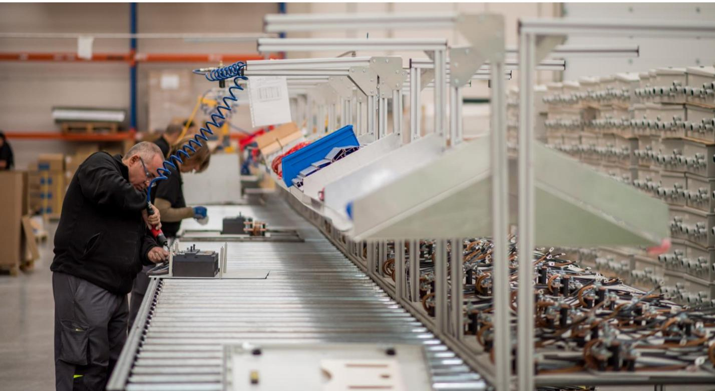
Además, tenemos un robot para mecanizados, cajeados y/o taladros en cajas o placas de PVC o poliéster, capaz de mecanizar casi 100 cajas al día y una herramienta neumática para pares de apriete, clave para asegurar la durabilidad y fiabilidad del producto en todos sus años de vida.
