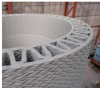
LafargeHolcim, GE Renewable Energy y COBOD, colaboran en un proyecto de diseño de materiales específicos para desarrollar aerogeneradores mediante impresión en 3D. LafargeHolcim afirma, además, que reduce los costes de producción y el tiempo de ejecución. Este sistema permite el diseño y desarrollo de aerogeneradores con alturas superiores a 200 metros.
