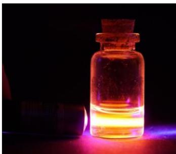
La Universidad Tecnológica Chalmers, Suecia, se atribuye el descubrimiento de una nueva técnica de aprovechamiento y almacenamiento de energía solar en un líquido. Éste funciona como una batería recargable que utiliza la radiación solar para cargarse y emitir calor cuando se precise energía. Según indican, el fluido puede desprender calor durante 18 años a altas temperaturas.
