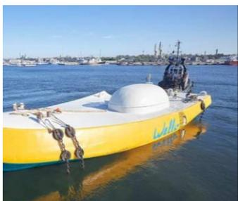
Penguin 2, prototipo de la empresa Wello, se encuentra en la plataforma BiMEP para aprovechar la energía de las olas y convertirla en electricidad. Se trata de un invento parecido a un barco, con un dispositivo giratorio en el interior que aprovecha el movimiento de las olas sobre el casco. Al estar conectado a un generador, produce electricidad.
