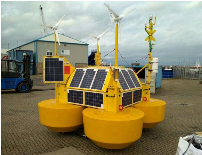
Fruto de un nuevo proyecto en desarrollo en el mar Báltico, a cargo de la empresa polaca PGE Báltico, se ha lanzado al mar una boya autónoma con energía solar fotovoltaica que deberá medir los datos del viento (velocidad, constancia y turbulencias) para la construcción de un parque eólico marino.
